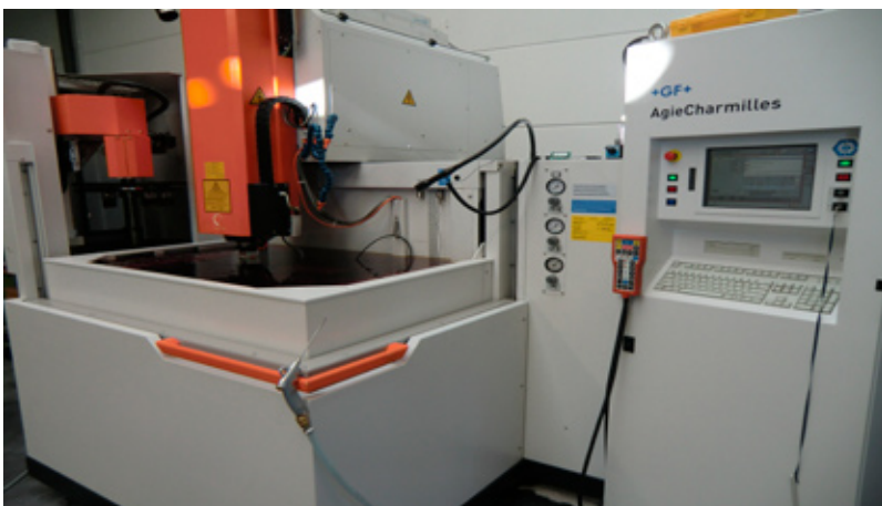
Senkerrodiermaschine 550 SP mit 32-fach Wechlser und Thermostabilisierung
